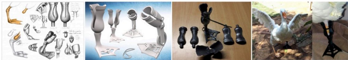
1. ร่างแบบ/เขียนแบบ 2. สร้างไฟล์ดิจิทัลสามมิติ 3. ชิ้นส่วนที่พิมพ์ด้วยระบบสามมิติ 4. ขาเปิดเทียม/วัสดุทดแทน
