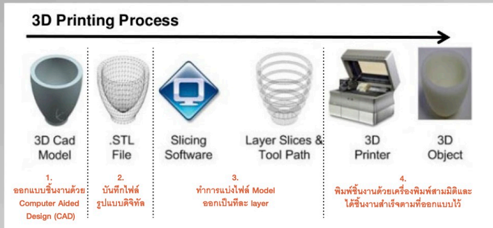
ภาพ 5 ขั้นตอนการสร้างไฟล์ดิจิทัลแบบสามมิติ เพื่อพิมพ์ชิ้นงาน ที่มา http://www.siamreprap.com/2015/10/what-is-3d-printer , http://www.applicadthai.com/articles/article-3dprinter/
